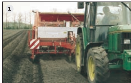
Une solution : le timon orientable mécanique ou hydraulique (1).
