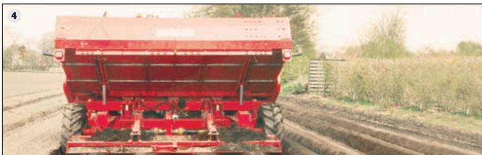
Enormes avantages : grâce aux deux grandes roues extérieures (4), pas de passage de roues entre les buttes. Ensuite, la cape formeuse se charge de la formation définitive des buttes.
