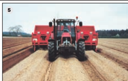
Une alternative à la plantation en billons 2 ou 4 rangs : le principe performant en trois billons, par lequel la planteuse est toujours tirée dans son axe central (5).
