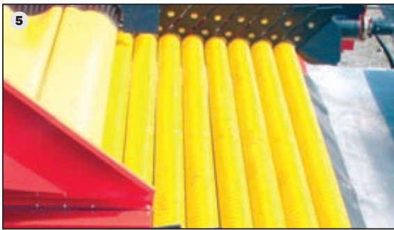
5 Augmenter la performance de déterrage : avec les deux spires polyuréthanes supplémentaires.
