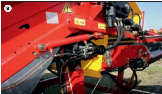
9 Une bonne alternative : avec le réglage hydraulique de l'inclinaison et de l'écartement. L'adaptation est encore plus flexible et encore plus confortable pour les exigences individuelles de stockage.
