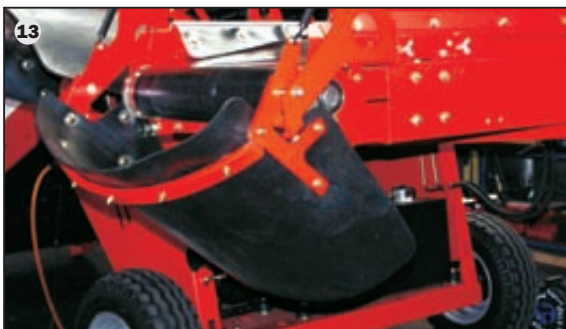
13 Très bon investissement : l'équipement de la bande de sortie produit avec la cascade de déchargement sur vérins pneumatiques. Votre avantage : la hauteur de chute est extrêmement réduite et les caisses sont remplies avec plus de douceur.
