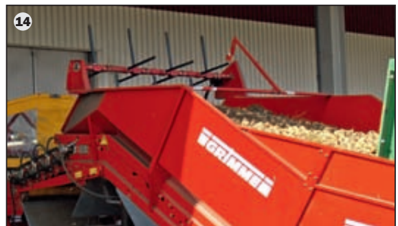
14 Le rôle brasseur à oignons est d'éliminer les paquets en brassant un produit léger du type oignons ou échalotes afin de désolidariser les gousses qui seraient agglutinées entre elles par la terre. Ainsi, le flux du fond mouvant vers les spires est constant.
