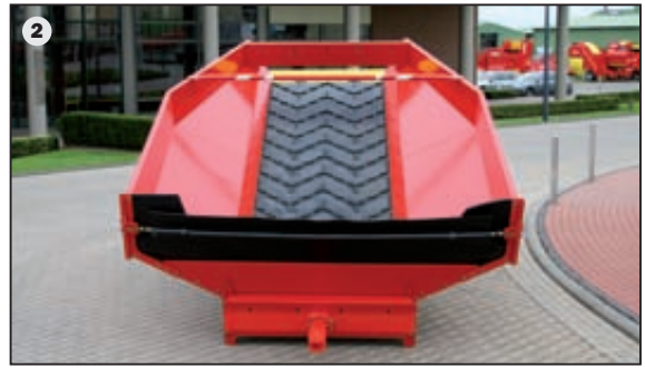
2 Grands avantages : avec la grande trémie (sans glissière d'écoulement) pour le RH 12-40 E ou le RH 16-40, vous augmentez le volume de la trémie.
