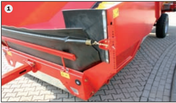
1 Toujours à bonne hauteur : avec la bavette de remplissage montée sur ressorts et en fonction du type de remorque, la hauteur d'ajustement est facilement réglable.
