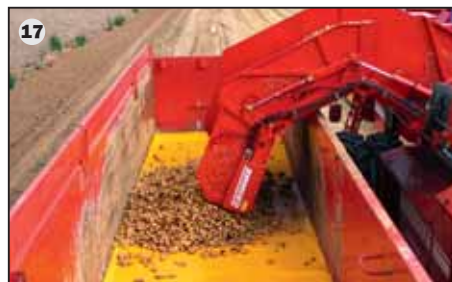
17 Qualité : à l'aide de 3 sections réglables hydrauliquement, le col de cygne de trémie s'enfonce dans la benne, ce qui réduit considérablement les hauteurs de chute lorsque la benne est vide. Pour plus de performance d'arrachage, il est possible de continuer l'arrachage pendant la vidange de trémie.
