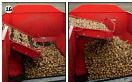
16 Pour maintenir une faible hauteur de chute, le col de cygne de la table de visite est soulevé successivement au fur et à mesure du remplissage (option).
