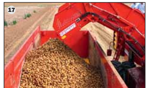
17 Qualité : à l'aide de 3 sections réglables hydrauliquement, le col de cygne de trémie s'enfonce dans la benne, ce qui réduit considérablement les hauteurs de chute lorsque la benne est vide. Pour plus de performance d'arrachage, il est possible de continuer l'arrachage pendant la vidange de trémie.
