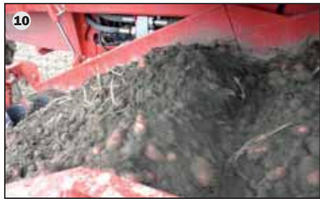
10 Plus vite : la chaîne ramasseuse (option) favorise l'entrée de la terre et son tamisage – sa vitesse est réglée hydrauliquement, indépendamment des autres chaînes pour s'adapter à toutes les conditions.
