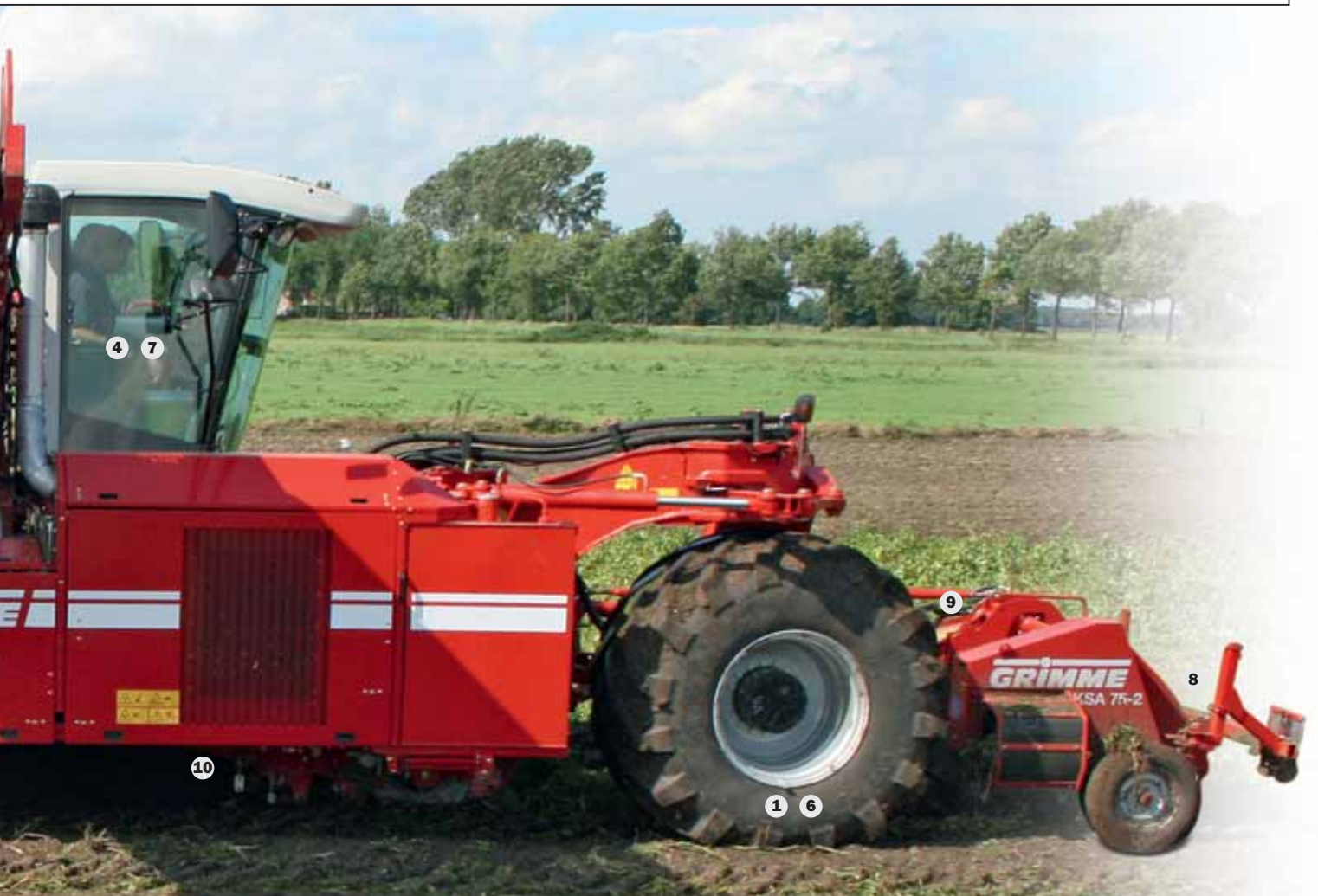
11 Agressif avec les fanes, doux avec les pommes de terre : avec la turbine d'effanage, le rouleau effaneur travaille contre une spire PU douce et déformable, au lieu de travailler contre les barreaux durs de la chaîne. En option, un réglage hydraulique en hauteur est disponible.
