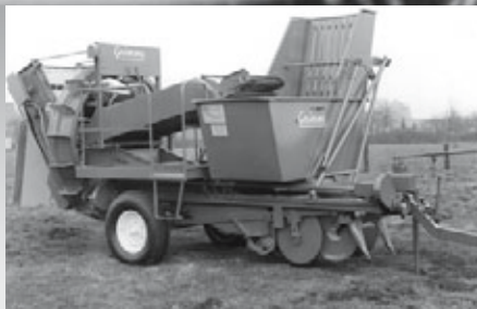
1966 : Grimme domine sur le marché grâce à la machine «Europa-Standard». Le relèvement des socs ainsi que la commande de trémie étaient hydrauliques.
