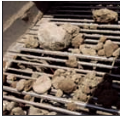
Jeder sechste Stab hat einen Durchmesser von 16 mm. Das bringt drei entscheidende Vorteile: Der Transport des Erdguts auf den Siebbändern wird optimiert, das Klutbrechen wird unterstützt sowie eine höhere Gesamtstabilität des Bandes bei großen Steinen erzielt.
