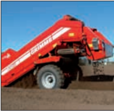
Alle Modelle sind standardmäßig mit einem Ablageband von nur 22 mm Stababstand ausgestattet.
