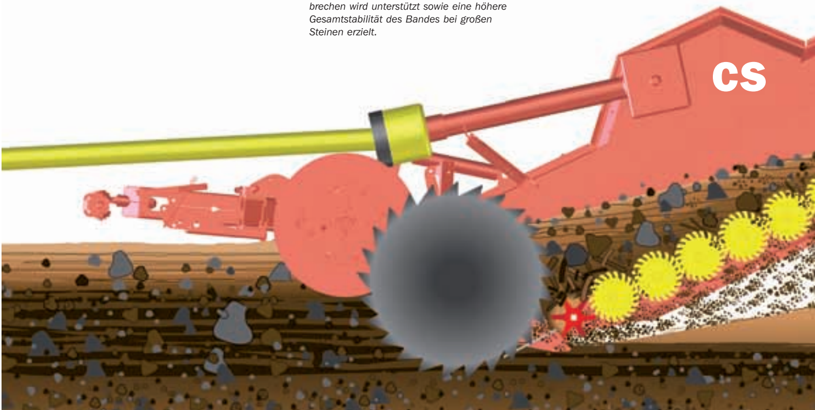
Alle Modelle sind standardmäßig mit einem Ablageband von nur 22 mm Stababstand ausgestattet.
