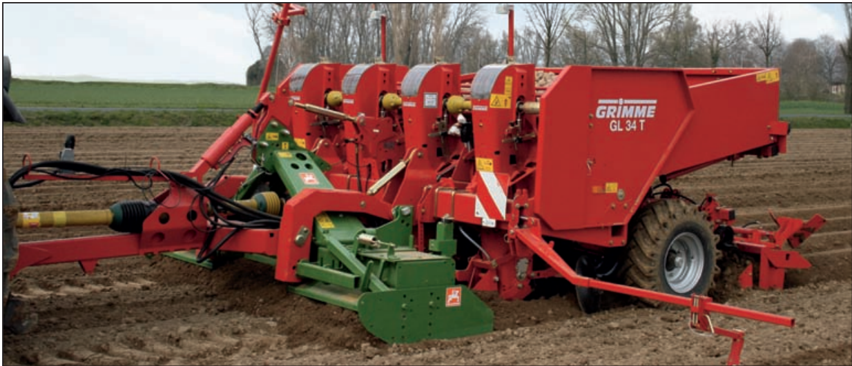
Gut gelöst: Unter der Zugdeichsel kann mit wenigen Handgriffen ein Amazone oder Lemken Kreiselgrubber eingesetzt werden.
