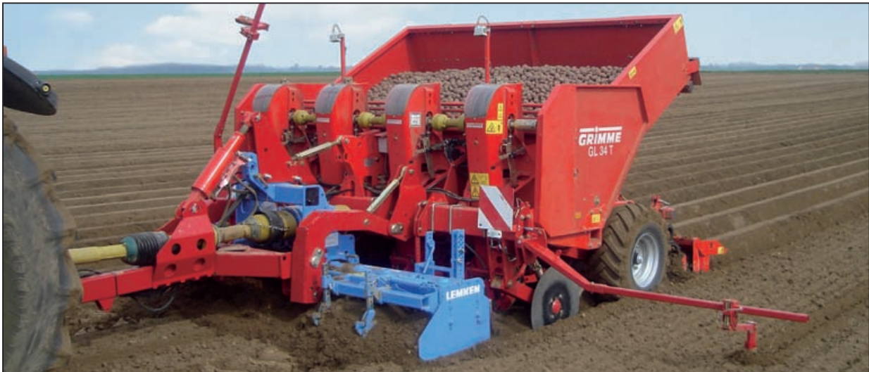
Die Arbeitstiefe ist wie beim Grimme Zinkenkrümler über hydraulische Zylinder einstellbar. Die Kreiselgrubberzinken sind 400 mm lang.
