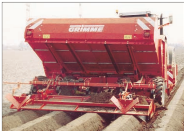
Dammaufbau durch große Zinken mit Dammformblech.
