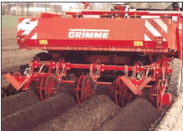
Eine Lösung für leichte Böden: die Legemaschine mit gefederten Häufelkörpern für den Dammaufbau – inklusive einzeln aufgehängter, einstellbarer Gitterrollen für leichtere Böden und bessere Wasseraufnahme.
