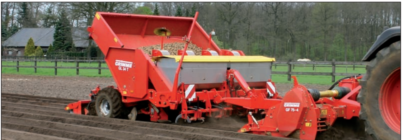
Das volle Programm für Profis: Die 5 in 1-Fräs-Lege-Kombination erledigt alle Arbeitsgänge in einem einzigen Schritt. Mittels Tiefenlockerungszinken mit Breitschar wird der Boden bis in die Tiefe aufgelockert – hervorragende Krümelung mit der Fräse.
