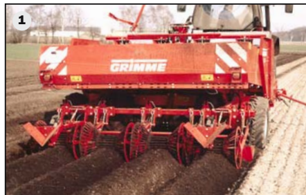
Eine Lösung für leichte Böden: die Legemaschine mit zusätzlichen gefederten Häufelkörpern für den Dammaufbau – inklusive einzeln aufgehängter, einstellbarer Gitterrollen für leichtere Böden und eine bessere Wasseraufnahme (1)
