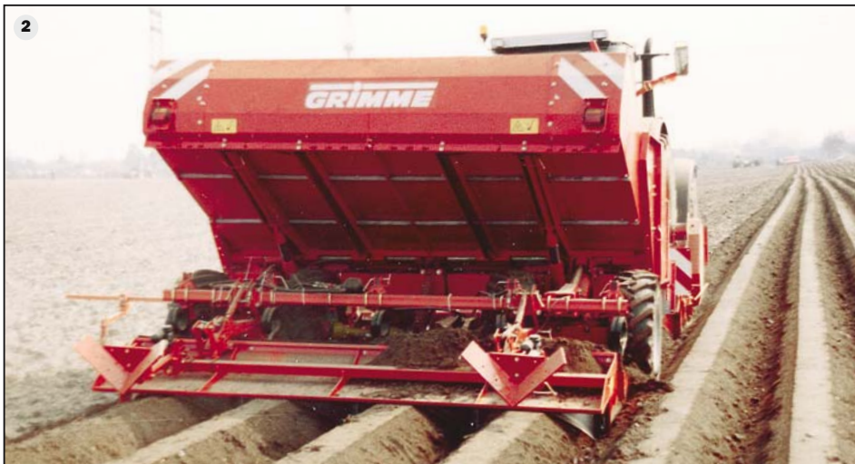
Eine Zusatzausstattung, die sich schnell bezahlt macht: Mit zusätzlichen gefederten Häufelkörpern und einem Dammblech sind Legen und Dammaufbau in einem Arbeitsgang möglich (2).
