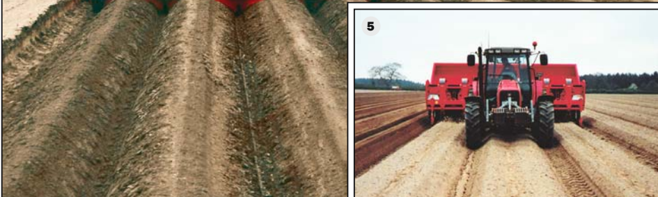
Die Alternative zum 2- und 4-reihigen Beetlegeverfahren: das leistungsstarke 3-Beet-Verfahren, bei dem die Legemaschine immer mittig gezogen wird (5)
