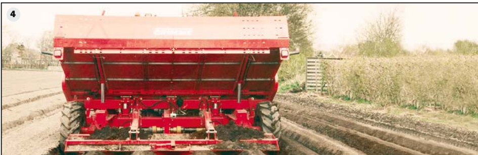
Große Vorteile: Dank der zwei großen Räder (4) fährt kein Rad durchs fertig angelegte Beet. Anschließend sorgt das Dammformblech für den Dammaufbau.
