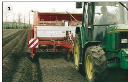
Eine Lösung: die mechanisch oder hydraulisch schwenkbare Deichsel (1)
