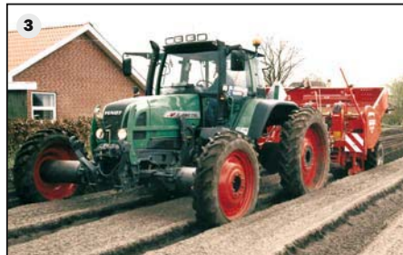
Mit Sicherheit weniger Grüne: Große Leitbleche (2) halten die Erde sicher im Beet. So breit, so gut: Der Schlepper über zwei Beete (3) mit Mitteldeichsel verhindert eine Verdichtung des Bodens zwischen den Beeten.
