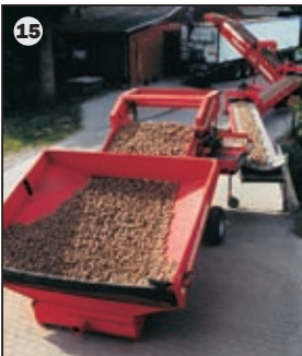
11 Komfortabel gelöst: der elektrisch geschaltete „Links-/Aus/Rechtslauf“ der Abfuhrbänder – optimal gesteuert über das Bedienterminal.
