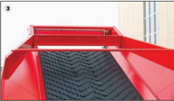
3 Gleichmäßig gut: Die Abzugskante des Schüttrichters für den RH 16-40, RH 16-40 E und RH 12-40 E führt zu einem einheitlichen Produktfluss – für die gleichmäßige Beschickung von Folgegeräten.
