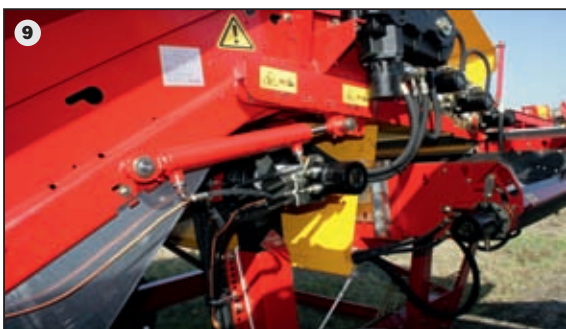
9 Gute Alternative: Mit der hydraulischen Neigungs- und Abstandsverstellung ist eine flexiblere und bequemere Anpassung an die individuellen Einlagerungsanforderungen möglich.
