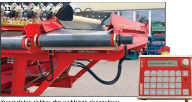
11 Komfortabel gelöst: der elektrisch geschaltete „Links-/Aus/Rechtslauf“ der Abfuhrbänder – optimal gesteuert über das Bedienterminal.
