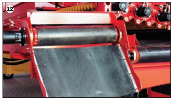
12 Für alle Fälle: Mit der Fallbremse wird das Erntegut abgebremst und sanft in die Kiste gelegt.
