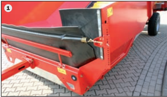
1 Immer auf der Höhe: Mit dem gefederten Einschüttutuch ist die Höhenanpassung an verschiedene Anhänger bequem mit wenigen Handgriffen erledigt.
