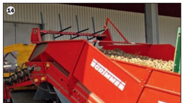
14 Löst Verhakungen: Die Zwiebelhaspel lockert den Produktstrom auf und sorgt so für eine schonende Übergabe zur nachfolgenden Enterdungseinheit.
