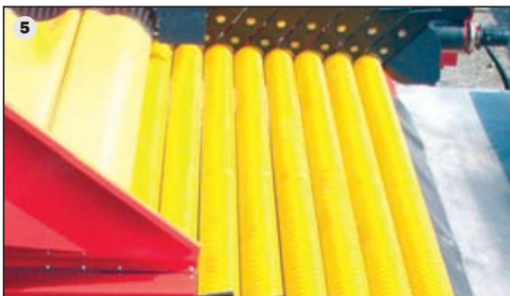
5 Erhöhen Sie die Reinigungsleistung: mit zwei zusätzlichen Polyurethan-Spiralwalzen
