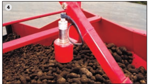
4 Erfolgreich mit System: Das CAPACITY-CONTROL-System regelt die Bunkerbodengeschwindigkeit automatisch und sorgt für eine optimale Beschickung der gesamten Einlagerungslinie. Ihr Vorteil: eine ideale Auslastung ohne manuelles Nachregeln. Die Steuerung erfolgt über einen Ultraschallsensor.
