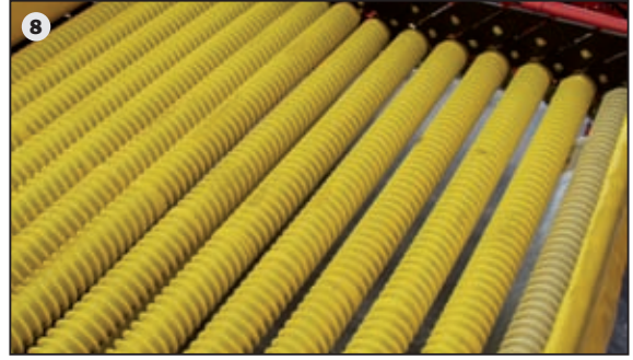
8 Für beste Trenn- und Sortierergergebnisse: Mit der Fraktioniereinheit mit bis zu 14 Polyurethan-Spiralwalzen (7+7 Walzen) lässt sich effektiv und schonend vorsortieren – sowie eine maximale Reinigungsleistung bei höchster Erntegutschonung, auch bei schwierigen Bedingungen, erzielen.
