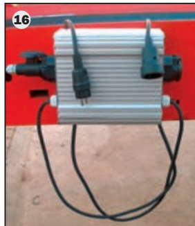
11 Komfortabel gelöst: der elektrisch geschaltete „Links-/Aus/Rechtslauf“ der Abfuhrbänder – optimal gesteuert über das Bedienterminal.
