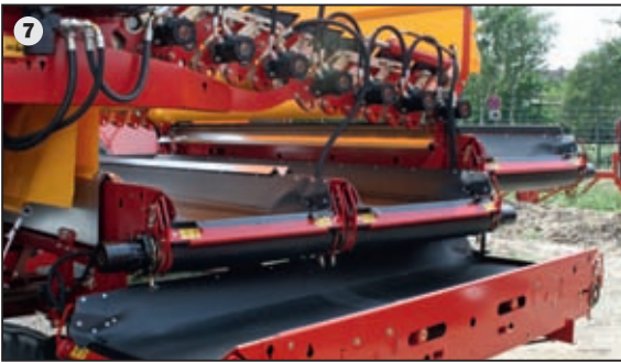
7 Gebündelte Abfuhr: Bei intensiver Ernterung mit 14 Walzen fallen große Erdmengen an. Das seitliche Abfuhrband bündelt diese Erde und gibt sie gemeinsam ab. So sparen Sie sich den Einsatz mehrerer langer Bänder.
