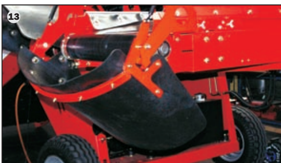
13 Lohnende Investition: die Ausstattung des Produktabfuhrbandes mit einem gasgefederten Fallsegel. Ihr Vorteil: Die Fallstufen werden drastisch reduziert und die Kisten noch schonender befüllt.
