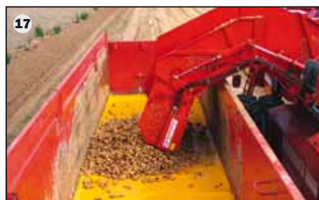
17 Eingestellt auf maximale Erntegutschonung: Das tiefe Eintauchen des Bunkerkopfes in den Anhänger – mittels 3 separat hydraulisch verstellbaren Bunkerkopf-Sektionen – reduziert die Fallstufen beim Entladen. Für mehr Flächenleistung ist eine Entladung während des Rodens möglich.
