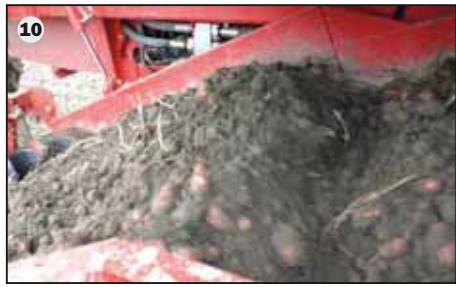
10 Damit läuft es gut: Mit dem optionalen Aufnahmeband wird die Erdabsiebung erhöht und damit die Siebleistung gesteigert. Je nach Rodebedingung kann die Geschwindigkeit entsprechend variiert werden.
