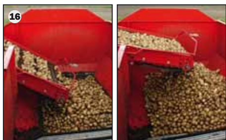
16 Befüllen für Profis: Die Befüllung des Bunkerbodens startet unmittelbar vom Bunkerboden. Für konstant niedrige Fallstufen wird das Befüllband über die optionale Vorsatzelevator-Automatik sukzessive angehoben. Gleichzeitig wird das Band bis zur vollständigen Befüllung vorgezogen.
