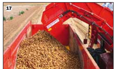
17 Eingestellt auf maximale Erntegutschonung: Das tiefe Eintauchen des Bunkerkopfes in den Anhänger – mittels 3 separat hydraulisch verstellbaren Bunkerkopf-Sektionen – reduziert die Fallstufen beim Entladen. Für mehr Flächenleistung ist eine Entladung während des Rodens möglich.
