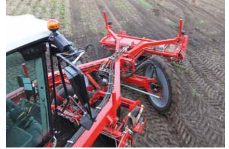
Besonders kleiner Wendekreis durch große Lenkeinschläge (60° vorn und 14° am Gurtbandlaufwerk)
