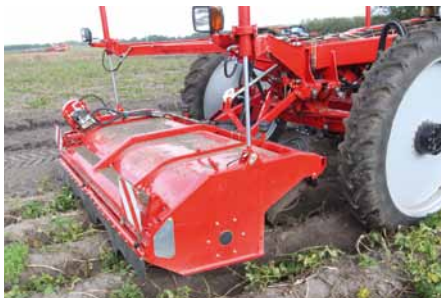
Kurzer, kompakter Krautschläger mit automatischer Tiefenführung
