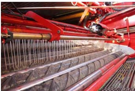
Hohe Variabilität: Kombination aus MULTISEP, Rollenseparator und Feinkrautelevator möglich
