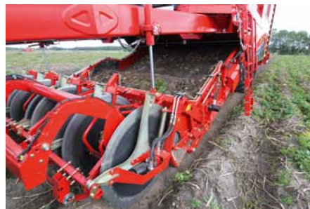
Breiter, durchgehender Siebkanal (2.800 mm) für hohe Leistung
