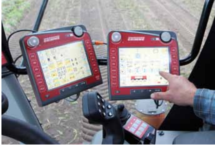
Komfortable Bedienung aller Sieb- und Trennaggregate per CCI-Terminal
