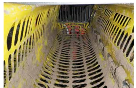
Option: Ringelevator mit neuer Taschenform (OPTIBAGS)
