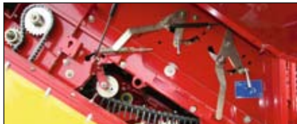
Manuell einstellbar: die 6 Rückhaltekömme (jeweils 3 oben und 3 unten) auf der Krautkette
