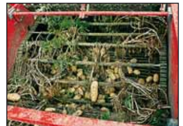
Grobkrautband ohne Feinkrautelevator (Option)
