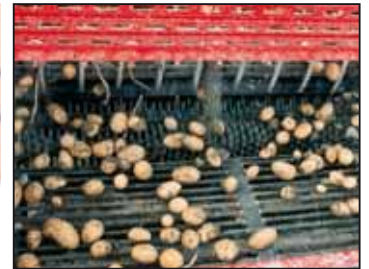
Zupfwalze in Kombination mit zwei Sternwalzen (Option)
