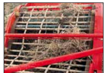
Grobkrautband mit Feinkrautelevator (Option)
