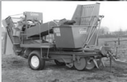
1966: Erlangung der Marktführerschaft durch das Zugpferd „Europa-Standard“. Scharaushebung sowie Bunkerbetätigung erfolgen hydraulisch.
