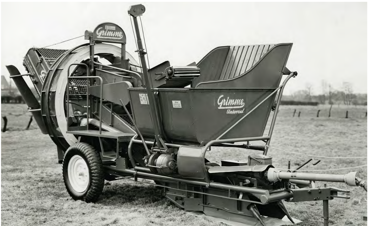
In der Ausführung SBU hat die Universal einen 12 Zentner großen Kippbunker zum Überladen der Kartoffeln auf einen Anhänger.
